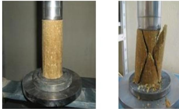
Fig 7. Eprouvette de tuf soumise à l'essai de compression.
