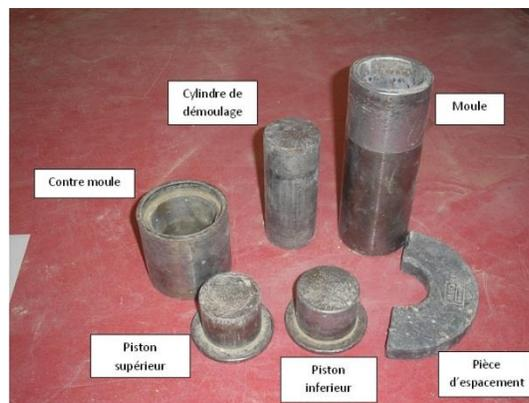
**Fig 3.** Eléments pour la confection d'éprouvettes cylindriques
