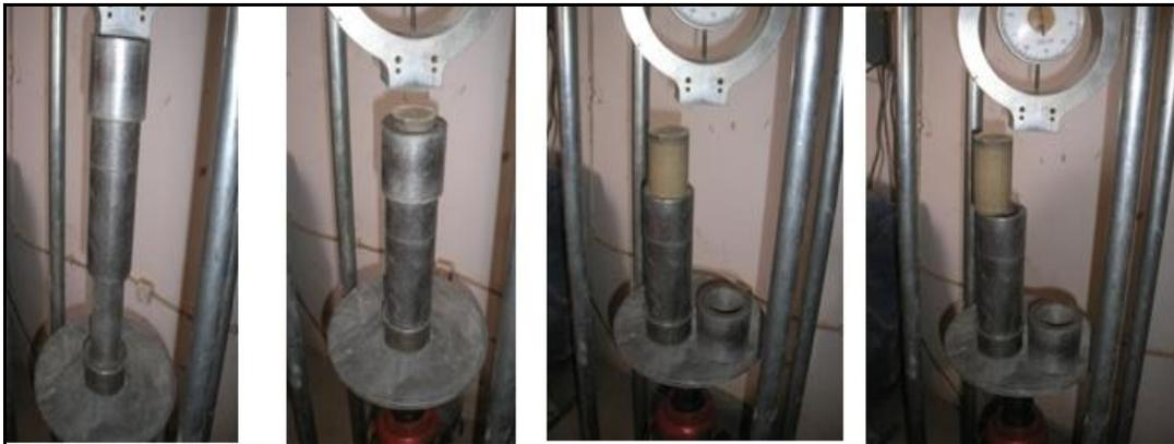
c) Démoulage de l'éprouvette
